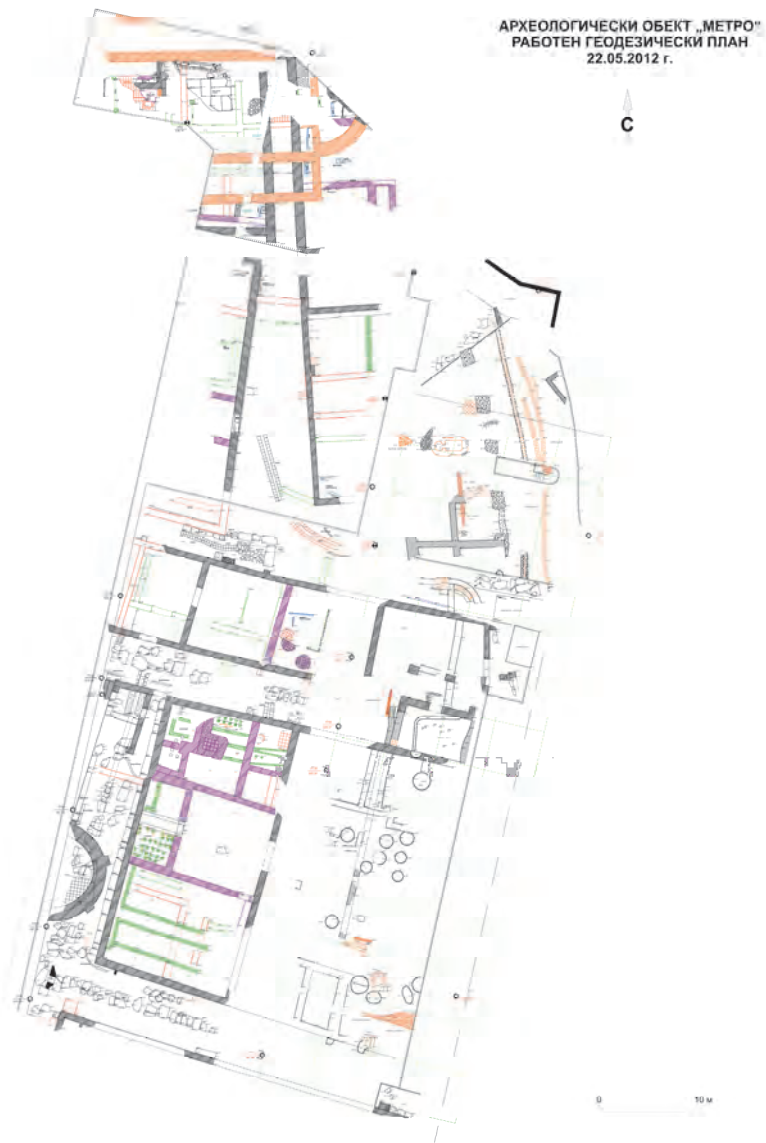
Обр. 1. Работен геодезичен план на обект „Метростанция 8-II“ с нанесени трасета на водопроводи от османския период в североизточния край на обекта. Чертеж: инж. А. Каменаров
